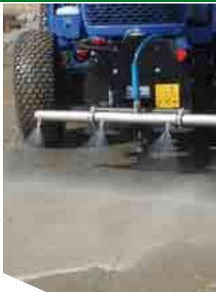
Meer water, minder druk. De sproeibalk verwijderd los vuil
